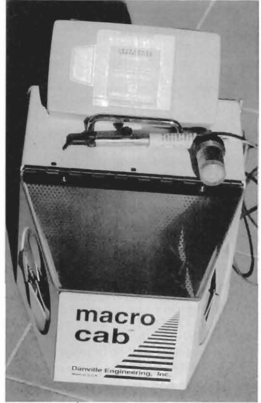
Resim 2: Araştırmada kullanılan kumlama cihazı ve vakumlu kumlama kabı
