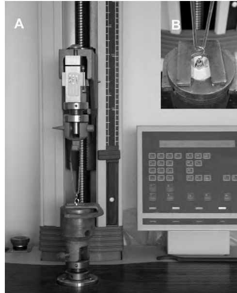
Şekil 2: A) Çekme test düzeneği, B) Braket tutucunun yakın görünüşü.
